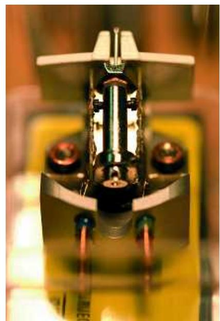
彼はそのネジを、アルミニウム、真鍮、ナイロン、チタン、その他様々な素材のネジに変えてみました。そしてネジを変える度ごとに厳密なリスニングテストを行ったのです。実際、音が劇的に変化するのを聴き、彼は衝撃を受けました。結果、最も音がよかったのは“3つのネジのうちひとつだけをチタン製のものと交換したとき”でした。
